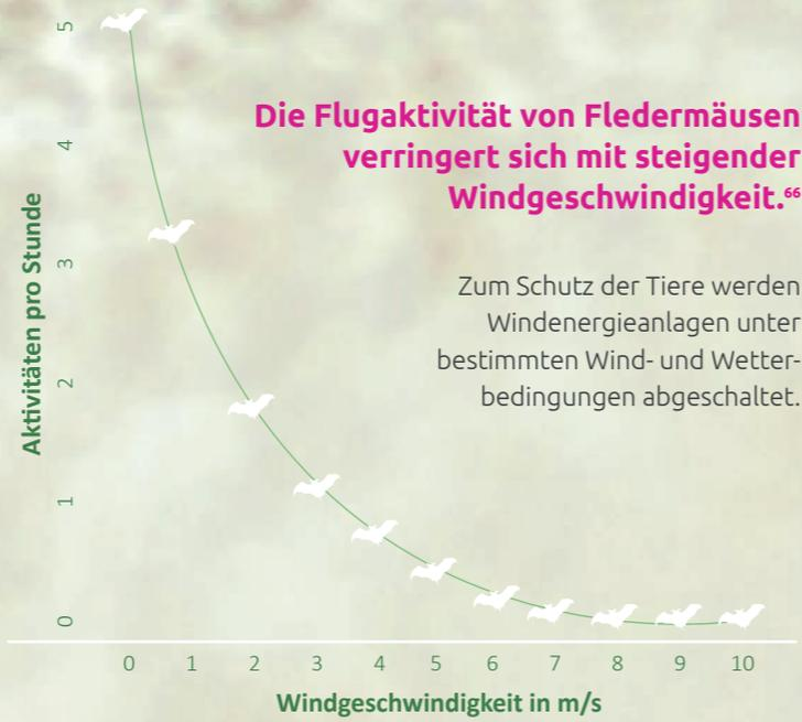
Zum Schutz der Tiere werden Windenergieanlagen unter bestimmten Wind- und Wetterbedingungen abgeschaltet.
